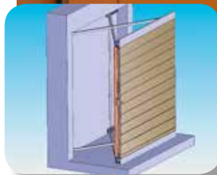
Öffnen und Ausfahren der Wandelemente
