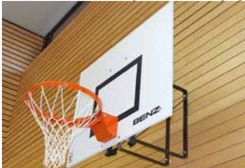
Basketball Wurfübungsanlage Starre Ausführung, Wandabstand 500mm, direkte Befestigung an der Wand, für Brettgröße 1200 x 900 mm. Bestehend aus 2 Haltern in Flachstahlschweißkonstruktion. Ohne Brett / Korb / Netz, GS-geprüft. 17258
